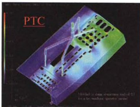
La simulazione dello stampo di un pannello di un fax ed il relativo rilevamento dei difetti: gli stress residui possono comportare variazioni dimensionali e deformazioni e sono dovuti ad uno sforzo di taglio e quindi a valori della temperatura localmente elevati.
